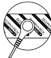
Joonis 1. Juhtme ja elektroodi ühendamise viis
