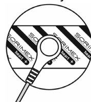
Slika 1. Način povezivanja žica i elektroda
