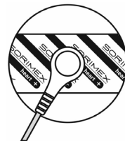
Des. 1. Cum se conectează firul la electrod
