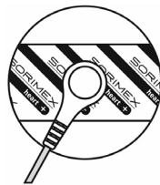
Attēls 1. Vadu un elektrodu savienojuma veids
