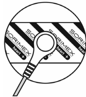
Attēls 1. Vadu un elektrodu savienojuma veids
