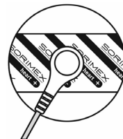
Des. 1. Cum se conectează firul la electrod
