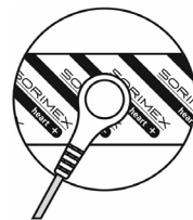
Fig. 1 Comment connecter le fil à l'électrode
