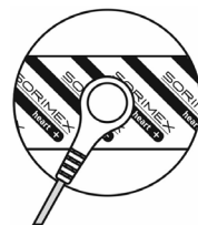
Fig. 1. Método de conexão do cabo ao eletrodo
