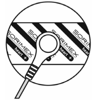
Abbildung 1. Art des Anschlusses des Kabels die Elektrode
