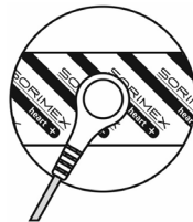
Рис. 1. Способ подключения провода к электроду
