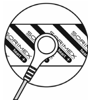
Attēls 1. Vadu un elektrodu savienojuma veids
