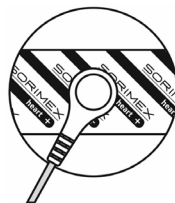
Obr. 1. Spôsob pripojenia kábla k elektróde
